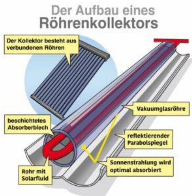
Abbildung 28: Aufbau eines Röhrenkollektors
